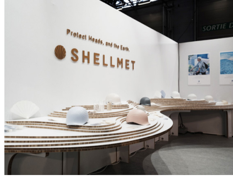
Stand Shellmet Maison & Objet - Janvier 2024 Stand entièrement fabriqué en carton blanc 白い強化段ボールを断面を見せながら重ねた什器
