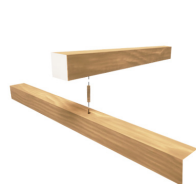
Assemblage par tourillons 簡単に組み立てられるダボを使用した木組み
